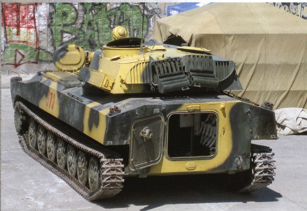
Самоходка 2С1, вид сзади. Хорошо виден открытый кормовой люк для посадки экипажа и загрузки боекомплекта, на корме башни закреплены гидродинамические щитки, которые устанавливаются перед преодолением водных преград.
