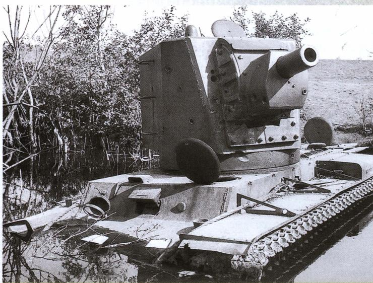
Литва, июнь 1941 года. Танк KV-2 из состава 2-й танковой дивизии Красной Армии вступил в бой с ротой танков 8-й танковой дивизии Вермахта у местечка Шета. Немцы смогли вывести его из строя, лишь повредив противоткатные устройства гаубицы.
