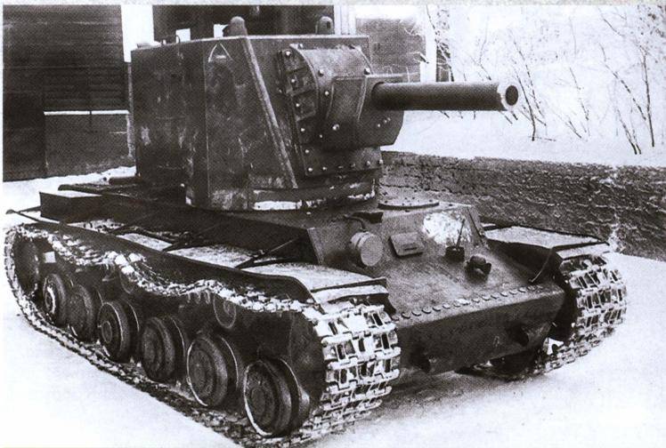
Танк KV № У-0 (опытный образец) с установленной на нем башней со 152-мм гаубицей М-10. Кировский завод, февраль 1940 года.
