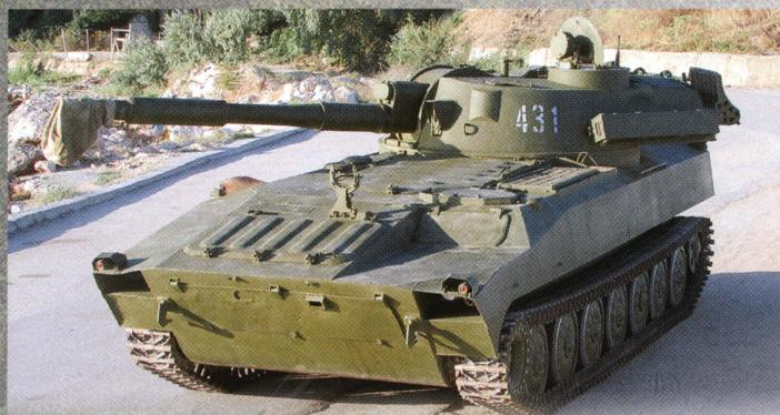
Самоходно-артиллерийская установка 2С1 «Гвоздика», вид спереди слева. На ствол гаубицы надет чехол, хорошо виден открытый люк командирской башенки.
