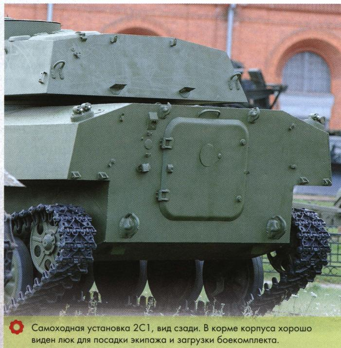
Самоходная установка 2С1, вид сзади. В корме корпуса хорошо виден люк для посадки экипажа и загрузки боекомплекта.
